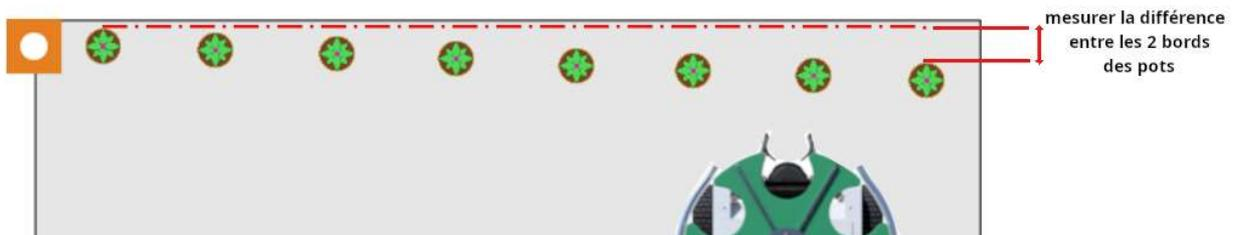
Dans cet exemple, nous avons **un décalage vers le bas** lors de la pose de la première ligne de pots. Il y a 8 pots qui ont été distancés. Nous mesurons une distance de bord à bord de 7 cm. Le réglage pour la correction sera le suivant :
