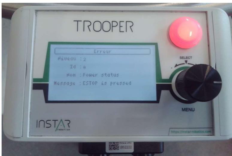
Une pression sur le bouton rotatif arrête le buzzer, et le boîtier de contrôle affiche l'écran principal. Le robot reste néanmoins en erreur.
