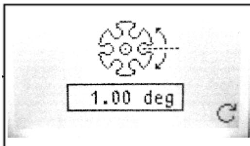
Le troisième sous-menu permet d'ajuster la position angulaire du magasin. Ce paramètre est réglé en usine et ne devrait jamais avoir à être modifié par la suite.
