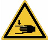
Des étiquettes ISO 7010 jaune sont apposées à la base des bras afin de signifier un danger d'écrasement des mains particulièrement élevé dans cette zone. **Ne jamais approcher un membre de la zone proche des étiquettes lorsque la machine est sous tension.**
