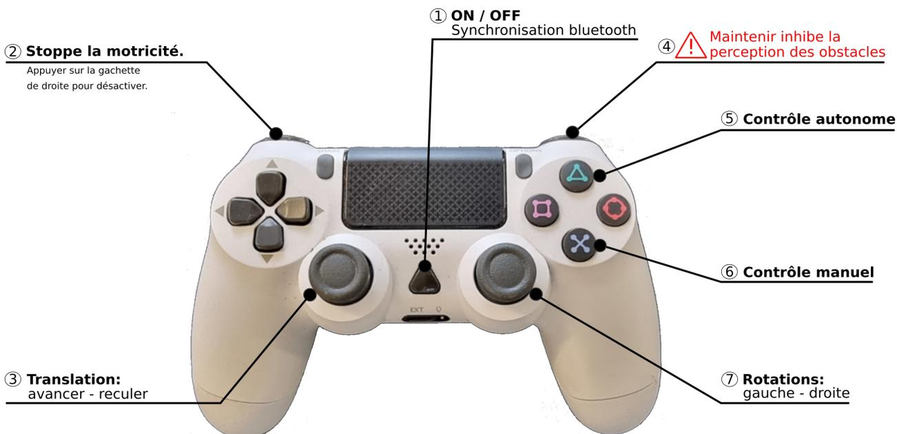
**1 – Bouton ON/OFF:** un appui bref lance la synchronisation avec le robot. Un clignotement lent indique une recherche de signal bluetooth (synchronisation en cours). Un clignotement du bouton peut également indiquer un faible niveau de batterie. Il faudra alors mettre en charge les 2 accumulateurs de la manette à l'aide d'un cable USB. Une fois synchronisé, le bouton s'allume de manière permanente, sans clignotement. Le contrôle du robot est alors possible.
