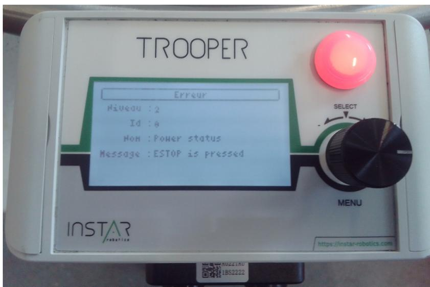
Un pression sur le bouton rotatif arrête le buzzer, et le boîtier de contrôle affiche l'écran principal. Le robot reste néanmoins en erreur.
